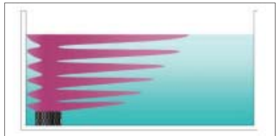
24. ábra: A jégtömb olvadásával járó áramlások vízszintes „nyelveket” formálnak
