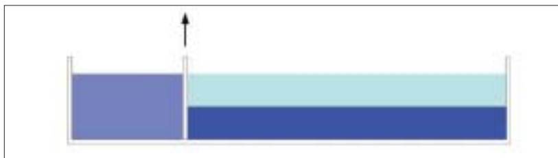
11. ábra: Közbülső front indítása: a bal rekeszben lévő víz a másik két réteghez képest köztes sűrűségű
