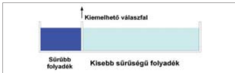
5. ábra: Átlátszó kísérleti kád kiemelhető válaszfallal, bal rekeszében sűrűbb folyadékot töltünk
