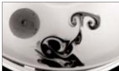
28. ábra: a) A forgatott, vízzel telt edény fenekén rögzített alacsony henger elé festéket fecskendezünk. b) A szétterjedő festék a 27. ábrának megfelelően függőleges felületek mentén oszlik szét a folyadék teljes mélységében (a felülnézeti képen ezért jelenik meg egy éles mintázat), de nem folyik rá a hengerre, hanem megkerüli a fölötte lévő vízoszlopot, a Taylor-oszlopot is
