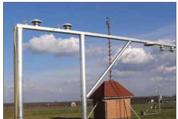
3. kép: A sugárzási egyenleg meghatározására szolgáló mérőrendszer
