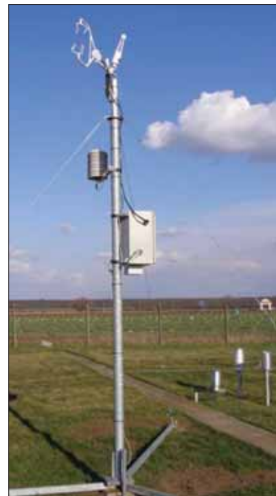
2. kép: A latens és szenzibilis hő áramok meghatározására szolgáló mérőrendszer
