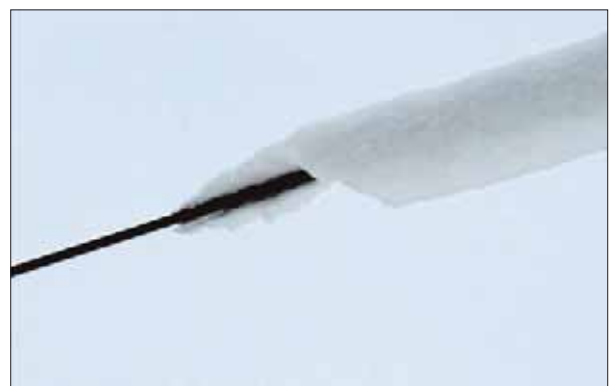
1. kép: Szabadvezetéken kialakult, körszimmetrikusan lerakódott tapadó hó.
