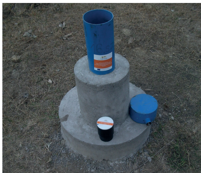
2. ábra. A MERIEXWA projekt keretében telepített egyik talajvízszint figyelő kút Szeged-Tápé külterületén. A kút előtt a vízszint érzékelésére alkalmas akusztikus szenzor látható.
